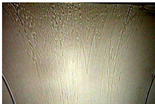
FIG. 3.14 – Photo d'un échantillon "très instable" recueilli en sortie de filière; T_f=270\text{ }^{\circ}\text{C} et T_p=286\text{ }^{\circ}\text{C}
