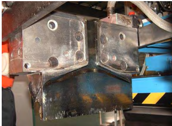
FIG. 3.3 – Photo de la filière industrielle (demi-filière ce qui révèle bien la géométrie en "portemanteau")
