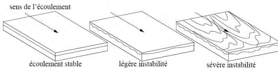
FIG. 2.1 – Schématisation d'instabilités d'interface en coextrusion (d'après [SBAH78])
