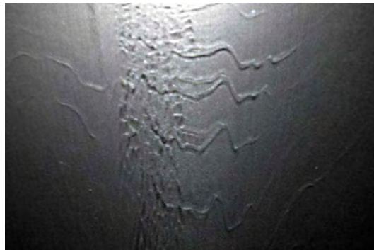
FIG. 3.12 – Échantillon "instable" recueilli en sortie de filière ; T_f=260\text{ }^{\circ}\text{C} et T_p=276\text{ }^{\circ}\text{C}
