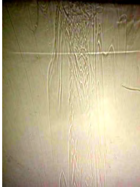
FIG. 3.13 – Photo d'un échantillon "instable" recueilli en sortie de filière; T_f=260\text{ }^{\circ}\text{C} et T_p=286\text{ }^{\circ}\text{C}
