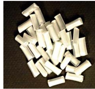
FIG. 1.1 – Granulé fibres longues de 12 mm, chargé à 30%
